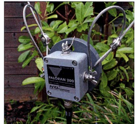
Bild 7: Untere Spitze der als Dreieck gespannten Schleife mit dem Übertragergehäuse Fotos: DF2BC
