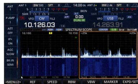
Bild 9: Beim Dual-Scope-Betrieb können die beiden Fenster auch nebeneinander liegen. Abstimmung und Scopes/Wasserfälle sind weitgehend unabhängig. Hier wird also der Haupt-Empfänger bedient (oben, weiß), während unten veränderte Einstellungen der Scopes/Wasserfälle (unten, orange umrandet) für den Sub-Empfänger gelten.
