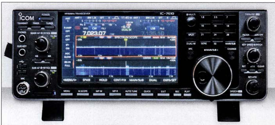
Bild 1: Die Frontansicht des IC-7610 wird von dem großen berührungsempfindlichen Display geprägt, das nicht nur die Scopes und Wasserfälle anzeigt, sondern auch bei einer Vielzahl von Bedienhandlungen von Bedeutung ist. Fotos und Screenshots: TO
