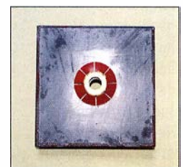
Bild 4: In der Mitte der Platte muss für die Kontaktfeder die Zinnschicht über dem Selen erhalten bleiben.
