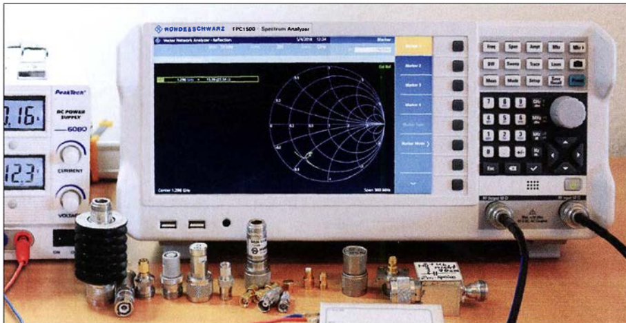
Bild 1: Spektrumanalysator FPC1500 von Rohde & Schwarz auf dem Messplatz; hier mit der aktivierten Ein-Port-VNA-Funktion, die eine Darstellung des Impedanzverlaufs im Smith-Diagramm erlaubt. Foto und Screenshots: DL2EWN
