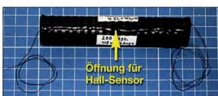
Bild 6: Die zur Kalibrierung verwendete Zylinderspule wurde auf ein Kunststoffrohr mit 22 mm Durchmesser gewickelt.
