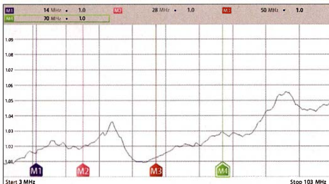
Bild 10: SWV eines 47- \Omega -Dickschichtwiderstands vom Typ RTO 50 F47 im Frequenzbereich von 3 MHz bis 103 MHz
