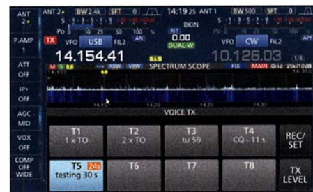
Bild 11: Sendespeicheraufruf per Schaltfläche (hier Telefonie mit Restzeitanzeige) beschränkt die Nutzung von Scope/Wasserfall.
