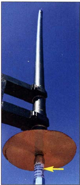
Bild 4: Selbst gebaute 8-Element-Collinear-Antenne für den ADS-B-Empfang auf 1,09 GHz; der TV-Sat-Vorverstärker befindet sich direkt am Fußpunkt (Pfeil)
