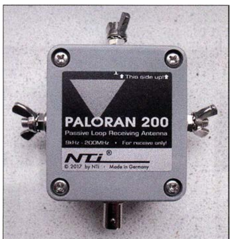
Bild 2: Übertragergehäuse mit den seitlichen Anschlüssen für die Schleife, die optionale Erdung (oben) und die BNC-Buchse für das Koaxialkabel
